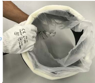
6. Ziehen Sie vorsichtig den inneren Teil des Dustbags außerhalb des Behälters entlang.
