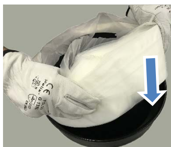
4. Vložte nový prachový pytel vnitřní stranou nahoru.
