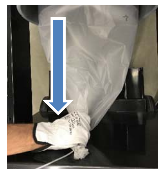
10. Ziehe an dem Dustbag und platziere den Kabelbinder am Ende, um einen neuen Beutel zu erstellen. Verwenden Sie bei Bedarf zwei Kabelbinder.
