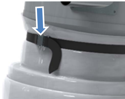
9. Das Innere des Dustbags auf die Position des Spanngurtes bringen. Den Dustbag mit dem Spanngurt an der Filterkammer festspannen.
