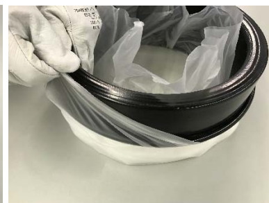
7. Vytáhněte vnější část prachového pytle a vytvořte nový pytel.
