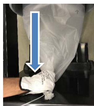
10. Vytáhněte prachový pytel a umístěte pásky na konec, aby vznikl nový pytel. V případě potřeby použijte dva kabelové vazače.
