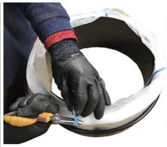
5. Schneiden und entfernen Sie die Verschlussbänder.
